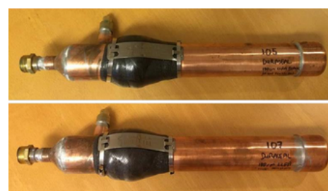
Solución de envoltura aprobada por DNV GL según la norma ISO 6182-1
